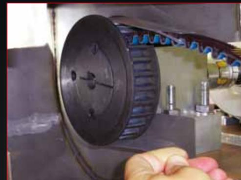
Une languette fournie avec chaque courroie permet de faciliter le passage autour des poulies dans les capotages.
