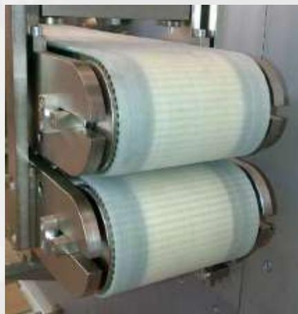
GATES TPU a conçu ces courroies dédiées au contact direct avec les aliments, et au transport de produits de grande largeur. Avec câbles aramide non noyés.
