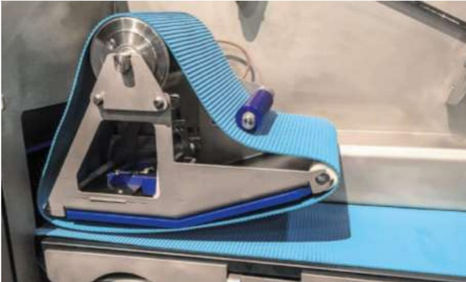
Il existe différentes **bandes structurées** dédiées au transport d'aliments en conformité avec les normes alimentaires CE 10/2011 et FDA/USDA.
